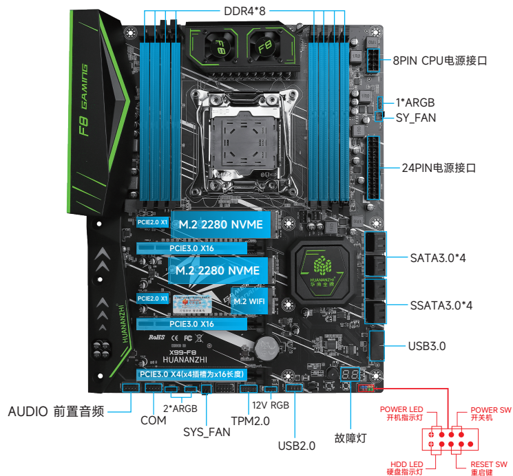
图1-1 X99-F8主板图解
